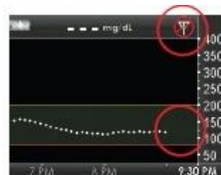
Символ нет связи на графике справа вверху и пробелы в данных
